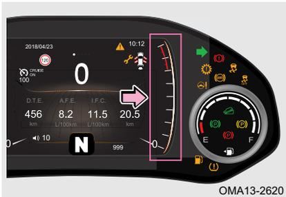
El tacómetro utiliza un puntero virtual para indicar la velocidad actual del motor (unidad:  $\times 1000$  rpm).
