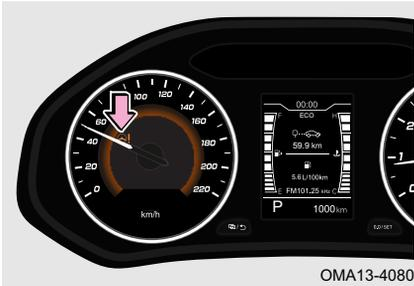
Si la batería del vehículo está apagada y se vuelve a conectar o arrancar, debido a la inicialización del ángulo del sistema de dirección asistida, el indicador amarillo "⚠" en el cuadro de instrumentos se parpadea, gire el volante hacia la izquierda y hacia la derecha hasta la posición límite para completar el restablecimiento del ángulo, y el indicador amarillo "⚠" en el cuadro de instrumentos se apaga.
