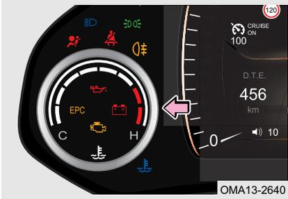
Este indica la temperatura actual de refrigerante del motor cuando el interruptor de arranque y parada del motor se cambia al modo ON.
