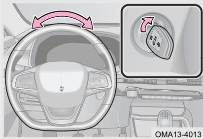
Inserte la llave y gire el interruptor de encendido de la posición de LOCK a la posición de ACC.
