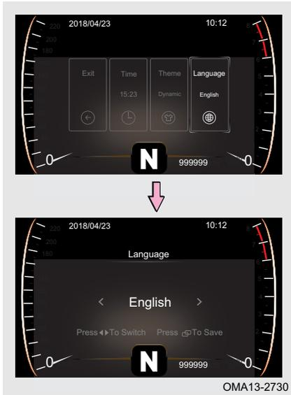
En la pantalla de ajuste de consulta, se puede ajustar el idioma mediante los botones de combinación del volante:
