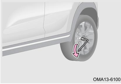
Antes de levantar el vehículo, gire los pernos de rueda que se reemplazarán en sentido antihorario para aflojarlos con una llave de tornillo. Coloque la llave de perno de rueda en el perno con su mango hacia la izquierda como se muestra en la ilustración. Sostenga el extremo final del mango y presione hacia abajo.
