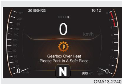
Si ocurre fallas e información anormal en el sistema detectada por la computadora a bordo del vehículo, después de que el interruptor de arranque y parada del motor esté encendido, la pantalla LCD muestra inmediatamente la información de alarma una por una y la registra en la pantalla de consulta de fallas.
