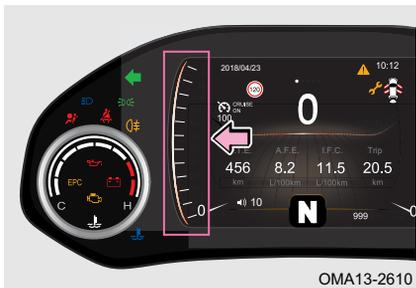
El velocímetro utiliza un puntero virtual y una pantalla digital central en la pantalla LCD para indicar la velocidad actual de vehículo (unidad: km/h).
