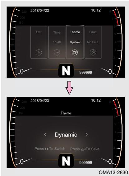
En la pantalla de ajuste de consulta, el tema se puede ajustar mediante los botones de combinación de volante:
