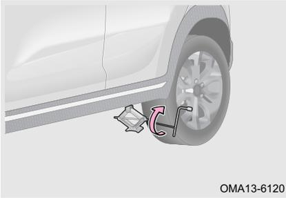
Cuando levante el vehículo, coloque el balancín de gato al gato y la llave de perno de rueda en el balancín de gato, y gire la llave de perno de rueda en el sentido antihorario. Una vez que el gato toca el vehículo y comienza a elevarse, verifique si la posición del gato es correcta.
