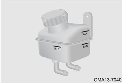
El nivel de líquido de frenos debería encontrarse entre las marcas "MIN" y "MAX". Si el nivel está en la marca "MIN" o debajo, agregue el líquido de frenos y comuníquese con la estación de servicio autorizada para su inspección y reparación inmediatamiento.
