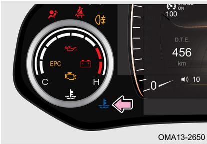
Enciende el motor, las imágenes y los mensajes de texto se mostrarán en la pantalla LCD, cuando la temperatura de refrigerante de motor es baja, el indicador azul de temperatura de refrigerante se enciende, indica que el motor está actualmente en estado de calentamiento.
