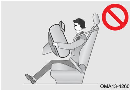
Mantenga siempre limpia la tura de inflado de airbag. Está prohibido poner cualquier cosa ( tal como teléfono móvil, etc.) entre el ocupante y el airbag. Está prohibido fijar o colocar cualquier objeto sobre o cerca de la cubierta de airbag. Si hay un objeto entre el ocupante y el airbag, es posible que el airbag no se despliegue de acuerdo con la ruta de diseño, o el airbag puede empujar objetos al cuerpo del ocupante, causando lesiones graves o incluso la muerte.
