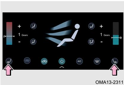
Después de arrancar el vehículo, pulse primero el interruptor de la calefacción del asiento en calefacción de 3 niveles (3 indicadores encendidos). Cada vez que se pulsa el interruptor, el nivel de calefacción se reduce en un nivel. Púlselo por cuarta vez para desactivar la calefacción del asiento.
